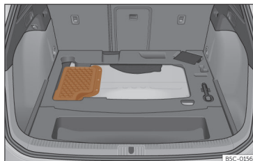
Fig. 227 Veículos híbridos (PHEV): localização da bateria na bagageira
