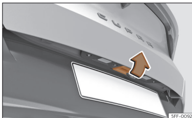
Fig. 81 Porta da bagageira: abertura a partir do exterior.
