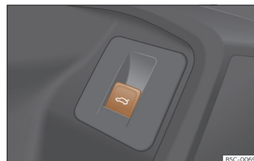
Fig. 83 Na porta do condutor: botão para abrir e fechar a porta da bagageira.
