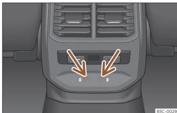
Fig. 175 Parte posterior consola central: conectores USB com função de tomada de corrente.
