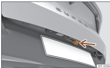
Fig. 133 No manípulo da porta da bagageira: localização da câmara do assistente para marcha-atrás.
