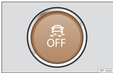
Fig. 126 Na parte inferior da consola central: botão para ligar/desligar o ESC.
