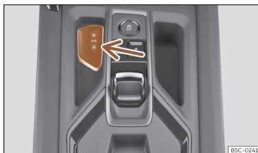
Fig. 70 Consola central (com caixa de velocidades automática): alojamento para a chave do veículo.
