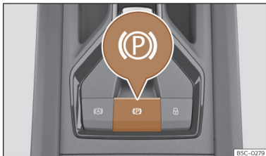
Fig. 152 Na parte inferior da consola central: botão do travão de estacionamento eletrônico.
