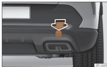
Fig. 210 No lado direito do para-choques traseiro: retirar a tampa.
