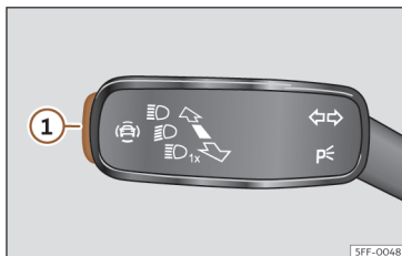
Fig. 61 No manípulo dos indicadores de mudança de direção e dos máximos: botão para os sistemas de assistência à condução (conforme versão).
