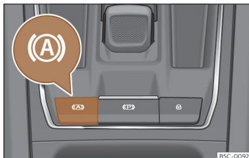
Fig. 176 Na parte inferior da consola central: tecla da função Auto Hold.
