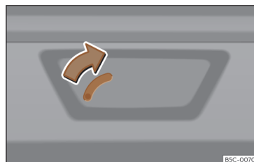
Fig. 87 Pormenor da bagageira: destrancagem de emergência.
