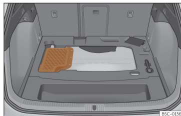
Fig. 217 Veículos híbridos (PHEV): localização da bateria na bagageira
