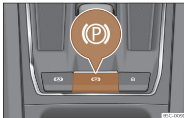
Fig. 175 Na parte inferior da consola central: tecla do travão de estacionamento eletrónico.
