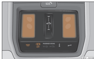
Fig. 94 Pormenor do forro do tejadilho: iluminação dianteira do habitáculo.
