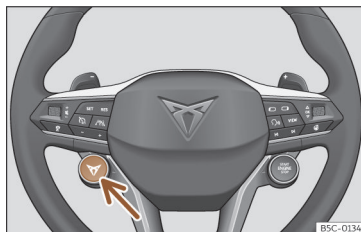
Fig. 147 Volante multifunções: botão para mudar o perfil de condução.
