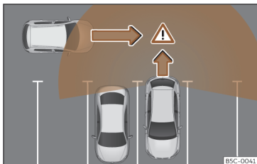
Fig. 172 Representação esquemática do assistente de saída do estacionamento: zona vigiada ao redor do veículo que está a sair do estacionamento.
