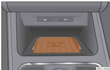
Fig. 138 Na consola central: alojamento para a ligação do telemóvel.
