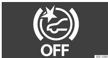
Fig. 158 No ecrã do painel de instrumentos: indicação de Front Assist desativado.
