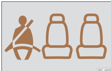
Fig. 5 Painel de instrumentos: indicação de lugar posterior esquerdo ocupado e cinto de segurança correspondente apertado.
