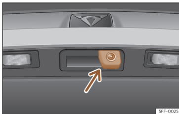
Fig. 153 No manípulo da porta da bagageira: localização da câmara do assistente de marcha-atrás.
