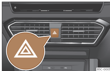
Fig. 93 Painel de instrumentos: interruptor das luzes de emergência
