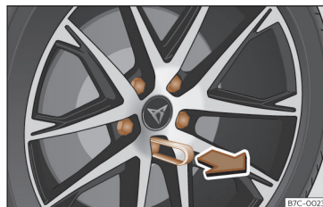
Fig. 35 Roda: parafusos da roda com protetores.
