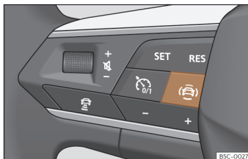
Fig. 62 Lado esquerdo do volante multifunções: botão para os sistemas de assistência à condução (conforme versão).
