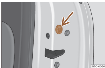
Fig. 80 Trancagem de emergência da porta.
