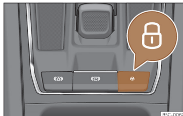
Fig. 76 Na consola central: interruptor do fecho centralizado
