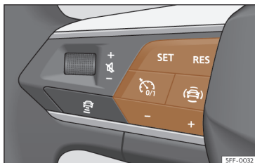
Fig. 155 No volante multifunções: botões para utilizar o limitador de velocidade
