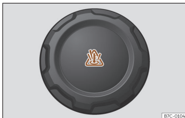
Fig. 214 Compartimento do motor: tampão do depósito de compensação do líquido de refrigeração.
