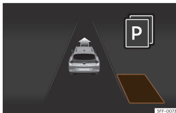
Fig. 178 No ecrã do painel de instrumentos: visualização do sistema de estacionamento assistido com visualização reduzida.
