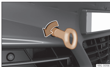
Fig. 184 Parte direita do para-choques dianteiro: argola de reboque enroscada.
