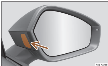
Fig. 131 Luz de controlo do assistente de mudança de faixa.
