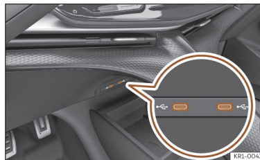
Fig. 155 Na consola central: entrada USB.
