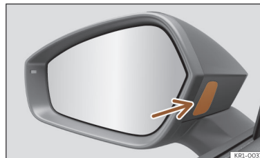
Fig. 130 Luz de controlo do assistente de mudança de faixa.
