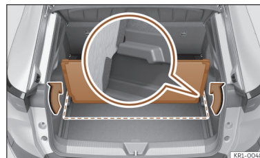
Fig. 166 Na bagageira: fixar o segundo piso da bagageira.
