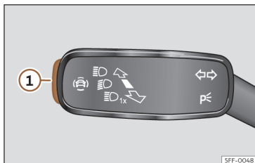
Fig. 99 Na alavanca das luzes indicadoras de mudança de direção e dos máximos: botão dos sistemas de assistência ao condutor (conforme versões).
