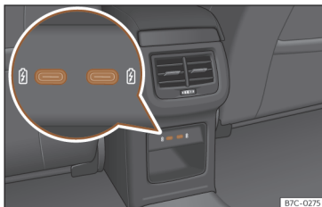
Fig. 154 Parte posterior consola central: conectores USB com função de tomada de corrente.
