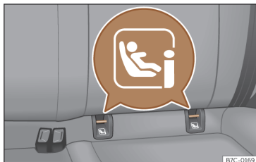
Fig. 35 Banco traseiro: localização dos anéis de fixação ISOFIX ou i-Size.
