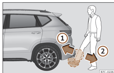
Fig. 57 Porta da bagageira com abertura controlada por sensor (Easy Open)
