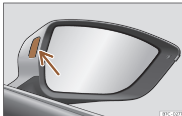
Fig. 124 Luz de controlo do assistente de mudança de faixa.
