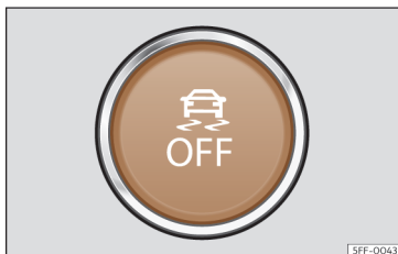
Fig. 98 Na parte inferior da consola central: botão para ligar/desligar o ESC (em função da versão).
