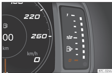
Fig. 3 Indicador do nível de combustível.
