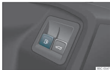
Fig. 196 Porta do condutor: desbloqueio da tampa do depósito
