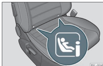
Fig. 28 Banco passageiro dianteiro: anéis de fixação ISOFIX/i-Size.
