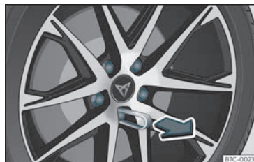
Fig. 35 Roda: parafusos da roda com protetores.
