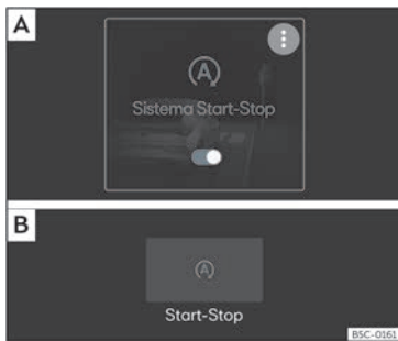
Fig. 140 No ecrã do sistema Infotainment: sistema Start-Stop ligado. [A] Vista no menu principal. [B] Vista com o sistema Infotainment desligado.
