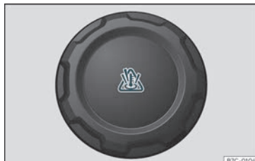
Fig. 207 Compartimento do motor: tampão do depósito de compensação do líquido de refrigeração.
