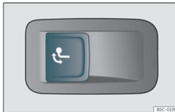
Fig. 185 No lado esquerdo da bagageira: botão para desbloquear o gancho de reboque.
