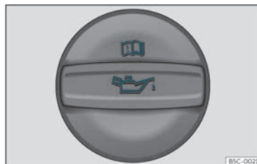
Fig. 204 Tampão do bocal de enchimento do óleo do motor no compartimento do motor.
