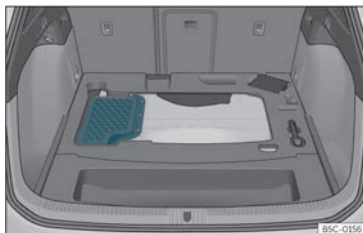
Fig. 211 Localização da bateria na bagageira
