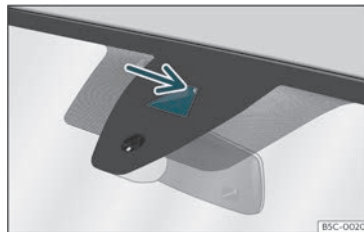
Fig. 147 No para-brisas: área de campo visual do sistema de aviso de saída da faixa de rodagem.
