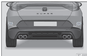
Fig. 148 Vista traseira do veículo: zonas dos sensores de radar.
