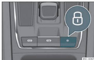
Fig. 75 Na consola central: interruptor do fecho centralizado
