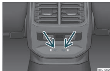
Fig. 137 Parte posterior consola central: Conectores USB com função de tomada de corrente.
