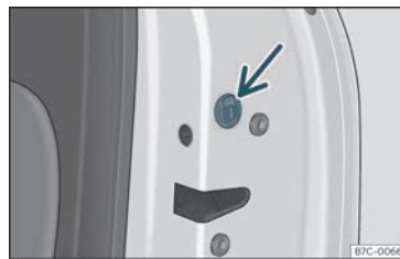
Fig. 79 Trancagem de emergência da porta.
