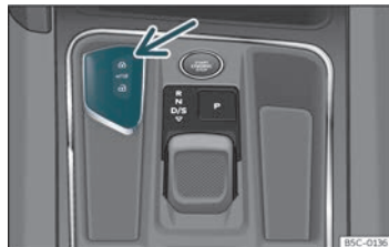
Fig. 70 Consola central: alojamento para a chave do veículo.
