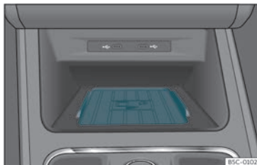
Fig. 135 Na consola central: alojamento para a ligação do telemóvel.
