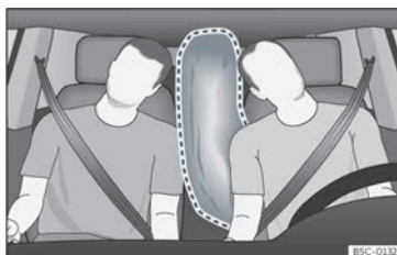
Fig. 20 Airbag central ativado totalmente (raio de alcance).
