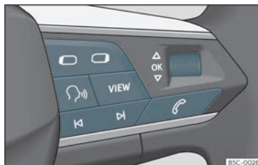
Fig. 60 Lado direito do volante multifunções: botões para utilizar os menus e as indicações informativas do painel de instrumentos (conforme versões).
