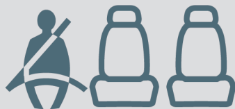
Fig. 5 Painel de instrumentos: indicação de lugar posterior esquerdo ocupado e cinto de segurança correspondente apertado.
