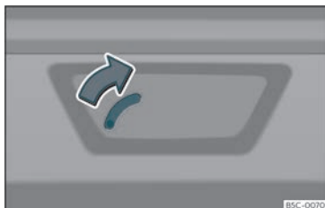
Fig. 85 Pormenor da bagageira: destrancagem de emergência.
