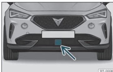
Fig. 145 No para-choques dianteiro: sensor de radar.
