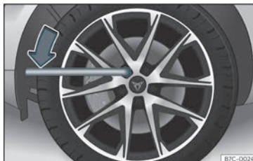
Fig. 37 Substituição da roda: despertar os parafusos da roda.
