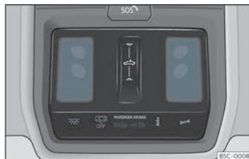
Fig. 92 Pormenor do forro do tejadilho: iluminação dianteira do habitáculo.
