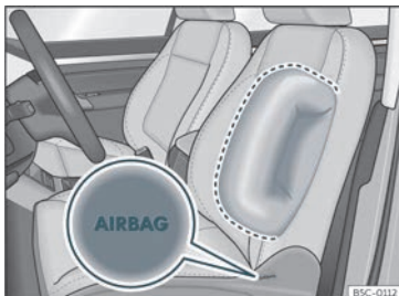
Fig. 21 Airbag lateral no banco do condutor.
