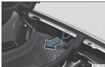
Fig. 192 Entre a lateral esquerda e a dobradiça do capô do motor; Puxador para o desbloqueio manual de emergência do conector de carregamento.
