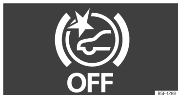
Fig. 155 No ecrã do painel de instrumentos: indicação de Front Assist desativado.
