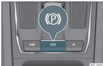
Fig. 172 Na parte inferior da consola central: tecla do travão de estacionamento eletrónico.
