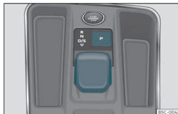
Fig. 142 Na consola central: comando seletor.
