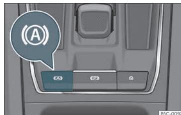
Fig. 173 Na parte inferior da consola central: tecla da função Auto Hold.
