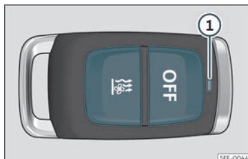
Fig. 129 Aquecimento estacionário: comando à distância por radiofrequência.
