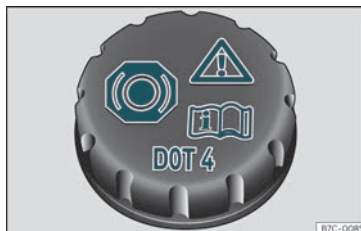
Fig. 208 Compartimento do motor: tampo do depósito do líquido dos travões.
