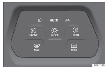
Fig. 89 Painel de instrumentos: comando das luzes.
