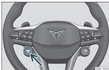
Fig. 144 Volante multifunções*: botão para mudar o perfil de condução.
