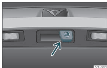
Fig. 150 No manípulo da porta da bagageira: localização da câmara do assistente de marcha-atrás.
