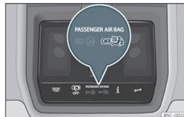
Fig. 16 Na consola do tejadilho: luz de controlo da desativação do airbag do passageiro.
