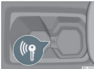
Fig. 139 Na consola central: arranque de emergência.
