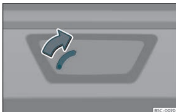
Fig. 85 Pormenor da bagageira: destrancagem de emergência.
