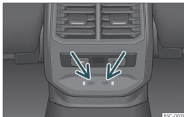
Fig. 141 Parte posterior consola central: Conectores USB com função de tomada de corrente.
