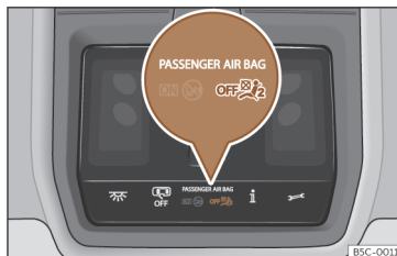
Fig. 20 Na consola do tejadilho: luz de controlo da desativação do airbag do passageiro.
