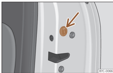
Fig. 84 Trancagem de emergência da porta.
