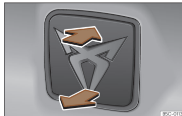
Fig. 86 Porta da bagageira: abertura por fora.
