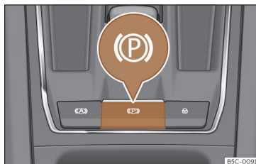
Fig. 187 Na parte inferior da consola central: tecla do travão de estacionamento eletrónico.
