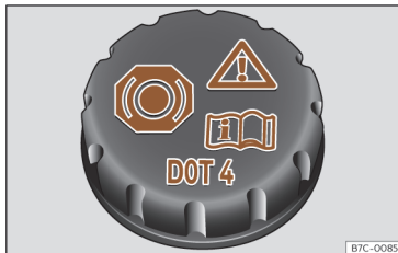
Fig. 225 Compartimento do motor: tam-pão do depósito do líquido dos travões.
