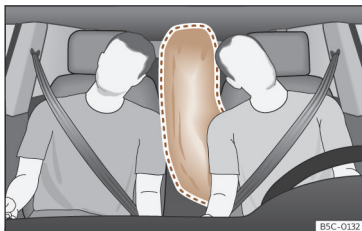
Fig. 24 Airbag central ativado totalmente (raio de alcance).
