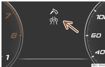
Fig. 59 Indicação da assistência para uma condução ecoeficiente (representação esquemática).
