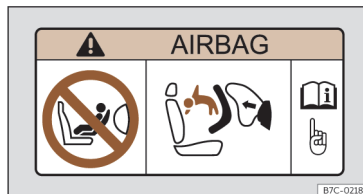
Fig. 29 Autocolante do airbag: na pala do sol do lado do passageiro
