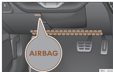
Fig. 21 No lado do condutor: localização do airbag de joelhos.
