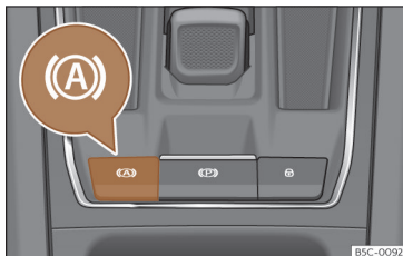
Fig. 188 Na parte inferior da consola central: tecla da função Auto Hold.
