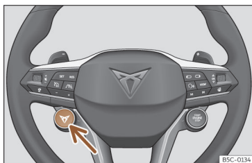
Fig. 159 Volante multifunções: botão para mudar o perfil de condução.
