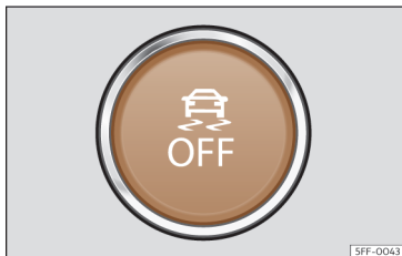
Fig. 189 Na parte inferior da consola central: botão para ligar/desligar o ESC
