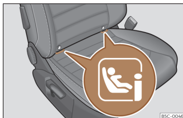
Fig. 32 Banco passageiro dianteiro: anéis de fixação ISOFIX/i-Size.
