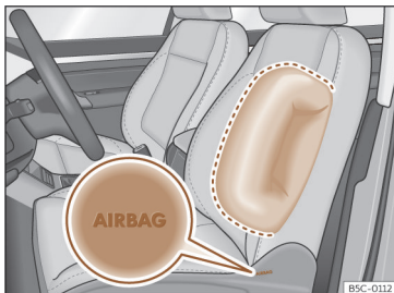
Fig. 25 Airbag lateral no banco do condutor.
