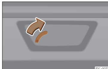
Fig. 91 Pormenor da bagageira: destrancagem de emergência (Leon Sportstourer).
