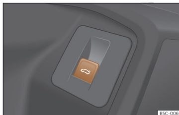
Fig. 88 Na porta do condutor: botão para abrir e fechar a porta da bagageira.
