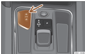
Fig. 75 Consola central: alojamento para a chave do veículo.
