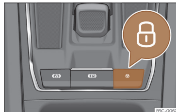
Fig. 80 Na consola central: interruptor do fecho centralizado
