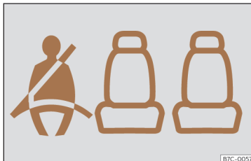
Fig. 9 Painel de instrumentos: indicação de lugar posterior esquerdo ocupado e cinto de segurança correspondente apertado.
