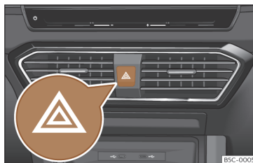
Fig. 97 Painel de instrumentos: interruptor das luzes de emergência
