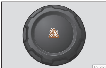
Fig. 224 Compartimento do motor: tampão do depósito de expansão do líquido de refrigeração.
