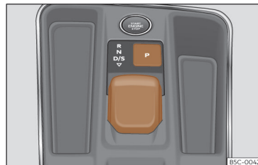
Fig. 157 Na consola central: comando seletor.
