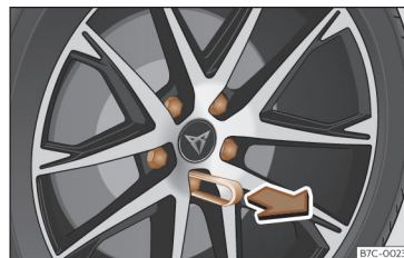
Fig. 39 Roda: parafusos da roda com protetores.
