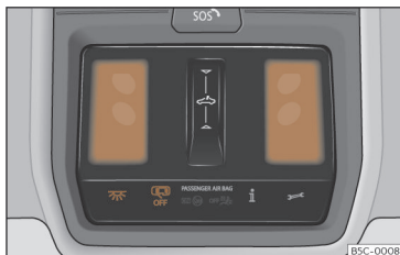
Fig. 89 Pormenor do revestimento do tejadilho: iluminação dianteira do habitáculo.
