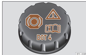
Fig. 177 Compartimento dianteiro: tampa do depósito do líquido dos travões.
