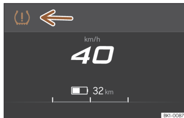
Fig. 187 Painel de instrumentos: aviso de perda de pressão dos pneus.
