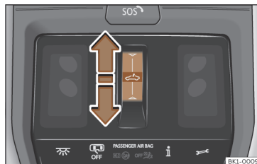
Fig. 96 No revestimento interior do teto: botão de função para utilizar a cortina de proteção contra o sol.
