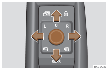
Fig. 94 Pormenor da porta do condutor: comando do espelho retrovisor exterior.
