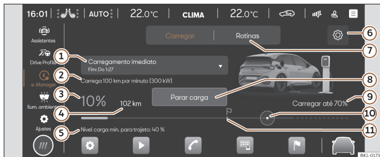
Fig. 58 No sistema de infotainment: menu Gestor energia nos ajustes do veículo.
