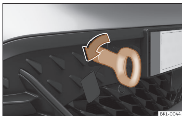
Fig. 168 Parte direita do para-choques dianteiro: argola de reboque enroscada.
