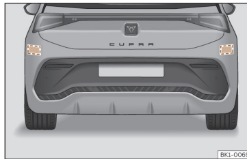
Fig. 105 Vista traseira do veículo: zonas dos sensores de radar.
