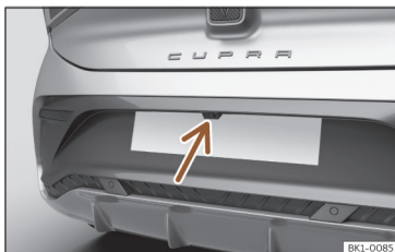
Fig. 107 No para-choques traseiro: localização da câmara do assistente para marcha-atrás.
