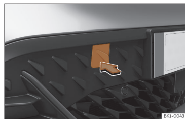
Fig. 167 No lado direito do para-choques dianteiro: retirar a tampa.
