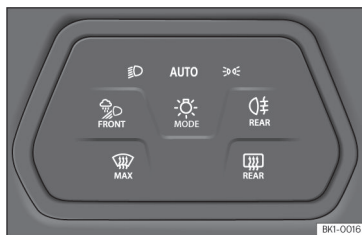
Fig. 87 Painel de instrumentos: comando das luzes.
