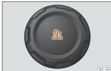
Fig. 176 Compartimento dianteiro: tampão do depósito de expansão do líquido de refrigeração.
