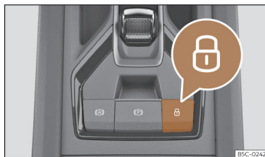
Fig. 77 Na consola central: botão do fecho centralizado.
