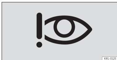
Fig. 7 No ecrã do painel de instrumentos: Símbolo do monitor de atenção do condutor.
