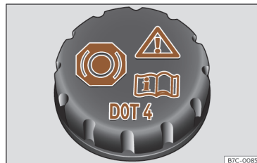
Fig. 227 Compartimento dianteiro: tampa do depósito do líquido dos travões.
