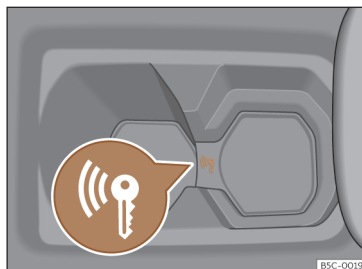
Fig. 119 Na consola central: arranque de emergência.
