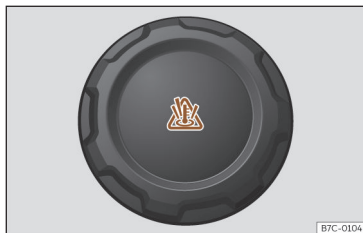
Fig. 226 Compartimento dianteiro: tampão do depósito de expansão do líquido de refrigeração.
