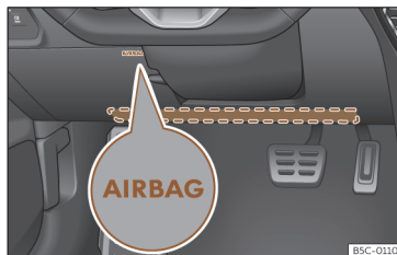
Fig. 34 No lado do condutor: localização do airbag dos joelhos.
