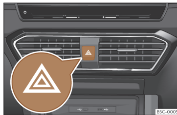
Fig. 49 Painel de instrumentos: interruptor das luzes de emergência.
