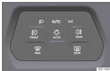
Fig. 106 Painel de instrumentos: comando das luzes.
