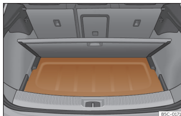
Fig. 182 Na bagageira: colocação da chapeleira.
