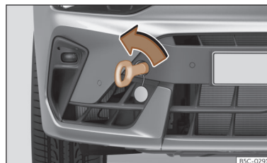
Fig. 216 Parte direita do para-choques dianteiro: argola de reboque enroscada.
