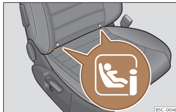
Fig. 40 Banco passageiro dianteiro: localização dos anéis de fixação i-Size.
