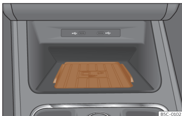
Fig. 178 Na consola central: alojamento para a ligação do telemóvel.
