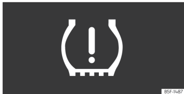
Fig. 247 Painel de instrumentos: aviso de perda de pressão dos pneus.
