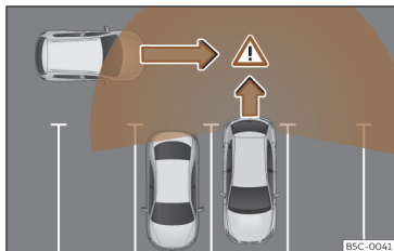
Fig. 163 Representação esquemática do assistente de saída do estacionamento: zona vigiada ao redor do veículo que está a sair do estacionamento.
