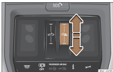
Fig. 90 No revestimento interior do teto: manusear a cortina de proteção contra o sol.
