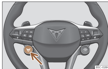
Fig. 125 Volante multifunções: botão para mudar o perfil de condução.
