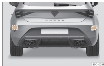
Fig. 131 Vista traseira do veículo: zonas dos sensores de radar.
