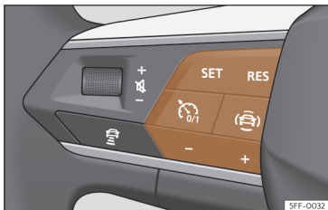
Fig. 127 No volante multifunções: botões para utilizar o regulador de velocidade.
