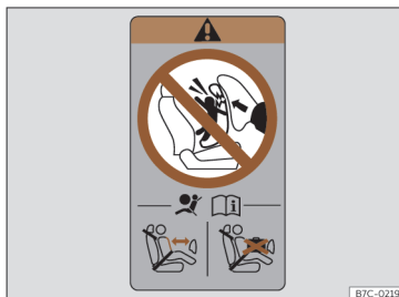
Fig. 40 Autocolante do airbag: na moldura posterior da porta do passageiro.
