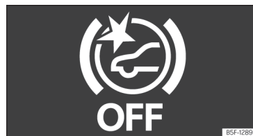
Fig. 136 No ecrã do painel de instrumentos: indicação de Front Assist desativado.
