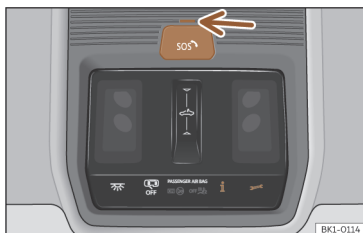
Fig. 50 Na consola do teto: comando para os serviços de voz.
