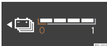
Fig. 5 Painel de instrumentos digital: indicador do nível de bateria.
