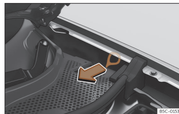
Fig. 59 Entre a lateral esquerda e a dobradiça do capô do motor Puxador para o desbloqueio manual de emergência do conector de carregamento.
