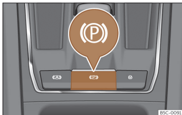
Fig. 145 Na parte inferior da consola central: botão do travão de estacionamento eletrônico.
