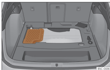
Fig. 225 Veículos híbridos (PHEV): localização da bateria na bagageira
