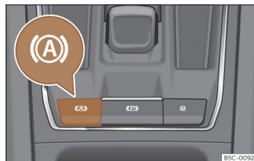
Fig. 146 Na parte inferior da consola central: botão da função Auto Hold.
