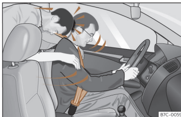
Fig. 22 O passageiro do banco traseiro que não tiver colocado o cinto de segurança é projetado para a frente, para cima do condutor que tem o cinto colocado.
