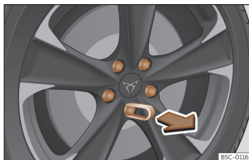
Fig. 233 Roda: parafusos de roda com protetores.
