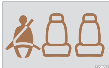
Fig. 20 Painel de instrumentos: indicação do estado dos cintos de segurança dos lugares traseiros.
