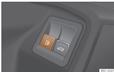
Fig. 200 Porta do condutor: desbloqueio da tampa do depósito.
