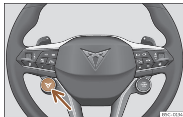
Fig. 117 Volante multifunções: botão para mudar o perfil de condução.
