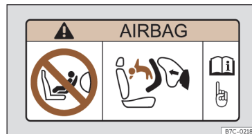
Fig. 34 Autocolante do airbag: na pala do sol do lado do passageiro.
