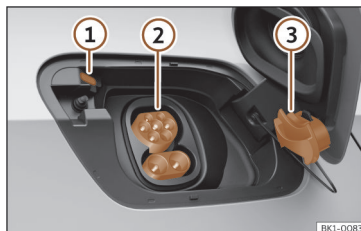
Fig. 58 Por trás da tampa da tomada de carregamento da bateria na parte dianteira esquerda: tomada de carregamento.
