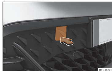
Fig. 177 No lado direito do para-choques dianteiro: retirar a tampa.
