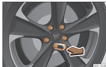
Fig. 193 Roda: parafusos de roda com protetores.
