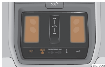
Fig. 95 Pormenor do revestimento do tejadilho: iluminação dianteira do habitáculo.
