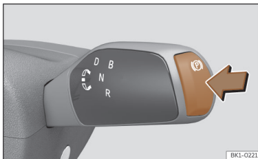
Fig. 133 No seletor de velocidades: botão do travão de estacionamento eletrónico.
