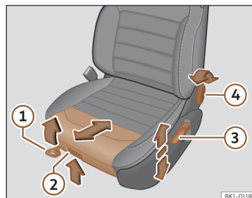
Fig. 84 Bancos dianteiros: ajuste manual do banco.
