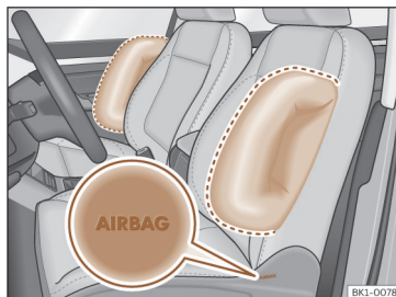
Fig. 30 Airbag lateral no banco do condutor e do passageiro.
