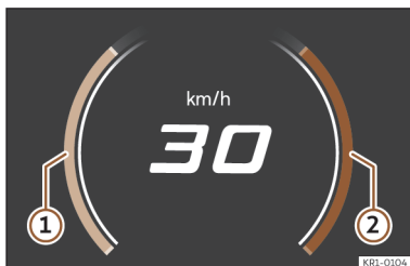
Fig. 3 No painel de instrumentos digital: indicador de potência (representação esquemática).
