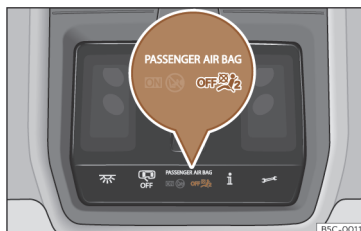
Fig. 27 Na consola do tejadilho: luz de controlo da desativação do airbag do passageiro.
