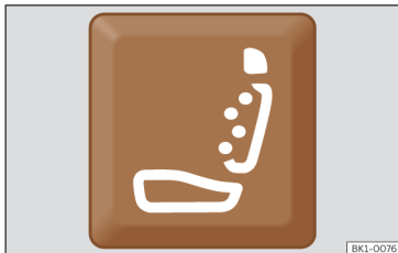
Fig. 92 Na parte lateral inferior do banco do condutor e do passageiro: botão da função de massagem.
