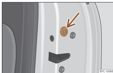
Fig. 76 Trancagem de emergência da porta.
