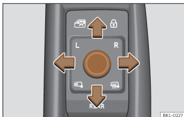
Fig. 99 Pormenor da porta do condutor: comando do retrovisor exterior.
