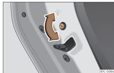
Fig. 77 Sistema de segurança para crianças da porta esquerda.
