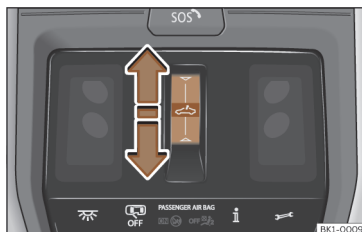
Fig. 101 No revestimento interior do teto: botão de função para utilizar a cortina de proteção contra o sol.
