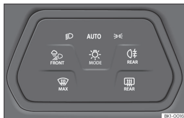
Fig. 93 Painel de instrumentos: comando das luzes.
