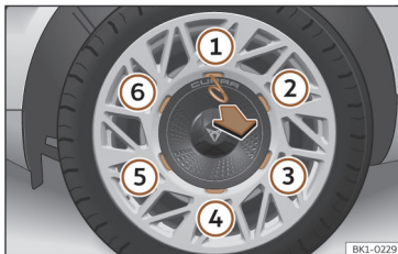
Fig. 192 Substituição da roda: desmontar o tampão central.
