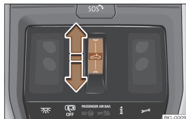
Fig. 115 No revestimento interior do teto: botão de função para utilizar a cortina de proteção contra o sol.
