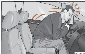
Fig. 40 O condutor que não tiver colocado o cinto de segurança será projetado para a frente.
