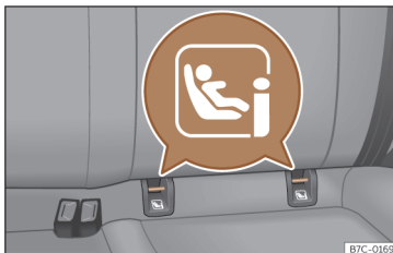
Fig. 58 Banco traseiro: anéis de fixação ISOFIX ou i-Size.
