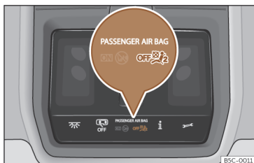
Fig. 49 Na consola do tejadilho: luz de controlo da desativação do airbag do passageiro.
