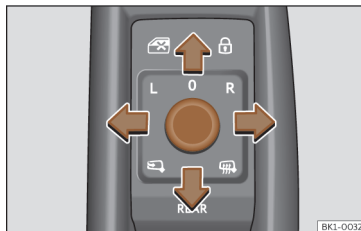
Fig. 113 Pormenor da porta do condutor: comando do espelho retrovisor exterior.
