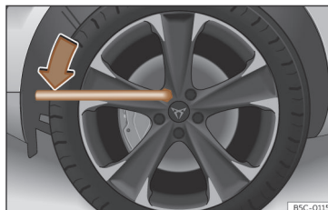
Fig. 200 Troca de roda: desapertar os parafusos de roda.
