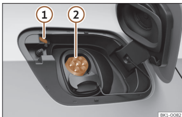
Fig. 72 Por trás da tampa de carregamento da bateria na parte traseira direita: Tomada de carregamento.
