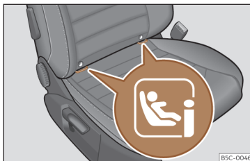
Fig. 59 Banco passageiro dianteiro: anéis de fixação i-Size.
