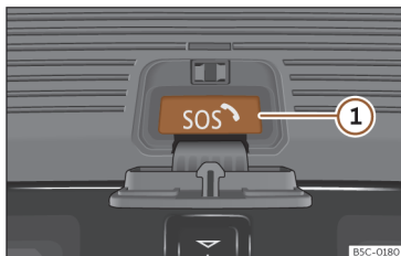
Fig. 65 Botão para chamada de emergência.
