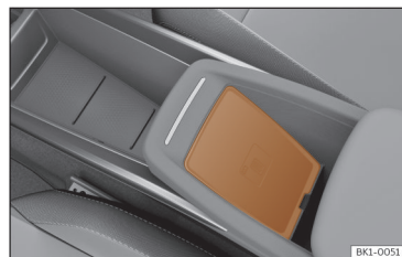
Fig. 167 Na consola central: alojamento para a ligação do telemóvel.
