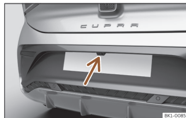
Fig. 126 No para-choques traseiro: localização da câmara do assistente para marcha-atrás.
