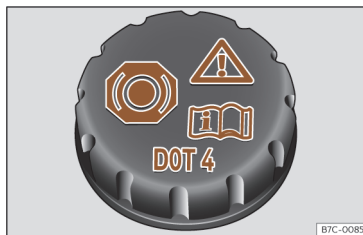
Fig. 193 Compartimento dianteiro: tampa do depósito do líquido dos travões.
