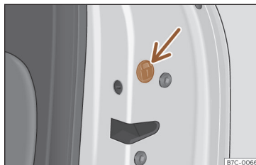
Fig. 90 Trancagem de emergência da porta.
