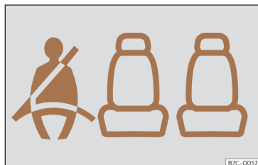
Fig. 38 Painel de instrumentos: indicação do estado dos cintos de segurança dos lugares traseiros.
