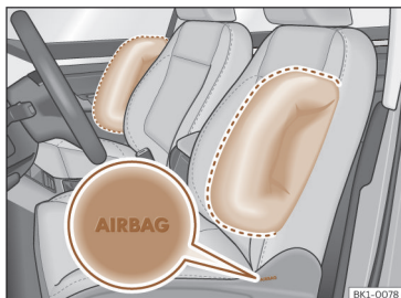
Fig. 52 Airbag lateral no banco do condutor e do passageiro.
