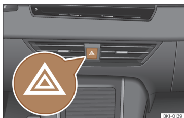
Fig. 63 Painel de instrumentos: interruptor das luzes de emergência.
