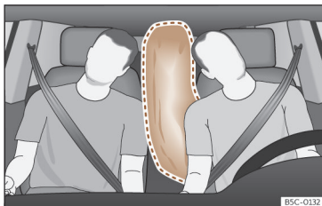
Fig. 51 Airbag central ativado totalmente (raio de alcance).
