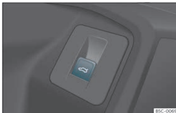
Fig. 87 Na porta do condutor: tecla para abrir e fechar a porta da mala.
