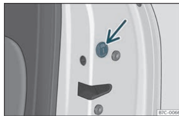
Fig. 83 Trancagem de emergência da porta.
