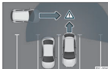
Fig. 183 Representação esquemática do assistente de saída do estacionamento: zona vigiada ao redor do veículo que está a sair do estacionamento.
