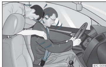
Fig. 12 O passageiro do banco traseiro que não tiver colocado o cinto de segurança é projetado para a frente, para cima do condutor que tem o cinto colocado.
