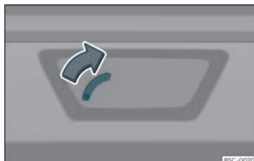
Fig. 90 Pormenor da bagageira: destrancagem de emergência (Leon Sportstourer).
