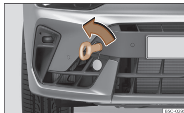
Fig. 220 Parte direita do para-choques dianteiro: argola de reboque enroscada.
