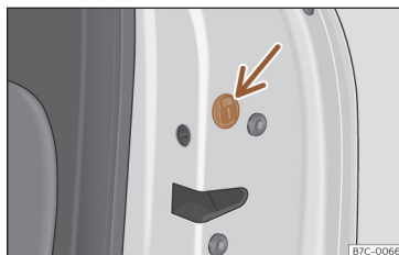
Fig. 76 Trancagem de emergência da porta.
