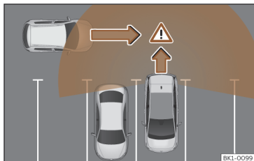
Fig. 147 Representação esquemática do assistente de saída do estacionamento: zona vigiada ao redor do veículo que está a sair do estacionamento.
