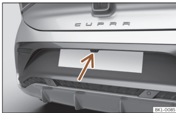
Fig. 114 No para-choques traseiro: localização da câmara do assistente para marcha-atrás.
