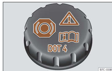
Fig. 187 Compartimento dianteiro: tampa do depósito do líquido dos travões.
