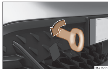
Fig. 178 Parte direita do para-choques dianteiro: argola de reboque enroscada.
