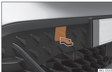
Fig. 50 No para-choques dianteiro direito: Retirar a tampa.
