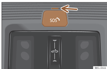
Fig. 45 Na consola do tejadilho: botão da função de chamada de emergência eCall (atrás da tampa do botão) e luz de controlo (seta).
