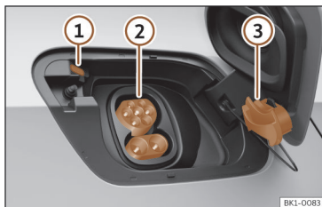
Fig. 18 Por trás da tampa da tomada de carregamento da bateria na parte dianteira esquerda: tomada de carregamento.
