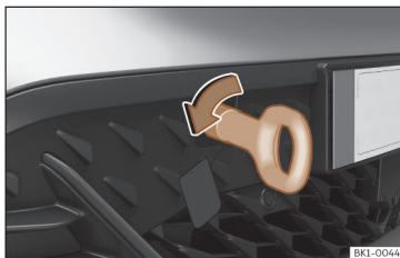
Fig. 51 No para-choques dianteiro direito: Enroscar a argola de reboque.
