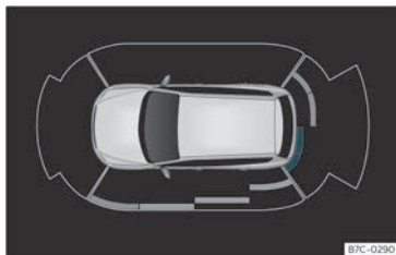
Fig. 185 Visualização do auxiliar de estacionamento no ecrã do sistema Infotainment.
