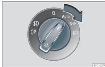
Fig. 92 Painel de instrumentos: comando das luzes.
