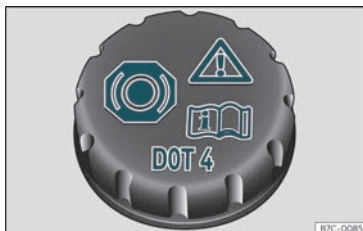
Fig. 206 Compartimento do motor; tampão do depósito do líquido dos travões.
