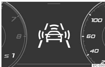
Fig. 158 No ecrã do painel de instrumentos: indicações de pré-aviso.
