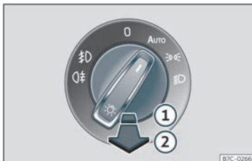
Fig. 93 Painel de instrumentos: comando das luzes.
