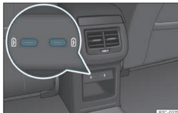
Fig. 138 Parte posterior consola central: conetores USB com função de tomada de corrente.
