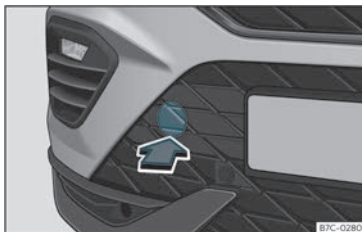
Fig. 41 No lado direito do para-choques dianteiro: retirar a tampa.
