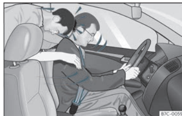
Fig. 8 O passageiro do banco traseiro que não tiver colocado o cinto de segurança é projetado para a frente, para cima do condutor que tem o cinto colocado.
