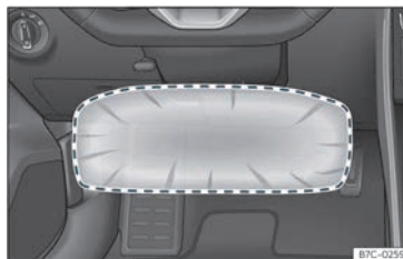
Fig. 18 No lado do condutor: raio de ação do airbag de joelhos.
