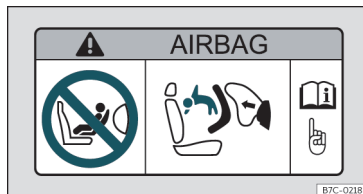
Fig. 23 Autocolante do airbag: na pala do sol do lado do passageiro
