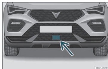
Fig. 148 No para-choques dianteiro: sensor de radar.
