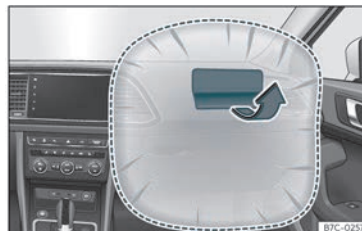
Fig. 14 Airbag do passageiro no painel de instrumentos.
