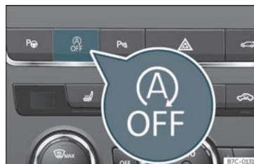
Fig. 141 Consola central: botão do sistema Start/Stop.
