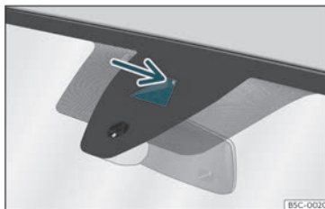
Fig. 150 No para-brisas: área de campo visual do sistema de aviso de saída da faixa de rodagem.
