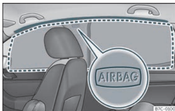
Fig. 21 Localização dos airbags da cabeça.
