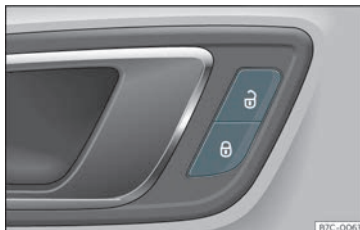
Fig. 75 Porta do condutor: interruptor do fecho centralizado.
