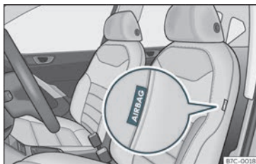
Fig. 19 Airbag lateral no banco do condutor.
