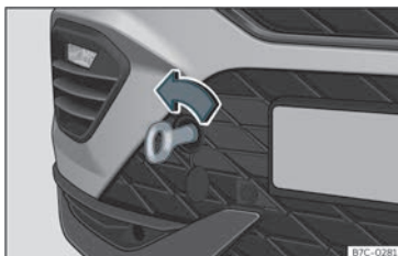
Fig. 42 No lado direito do para-choques dianteiro: argola de reboque enroscada.
