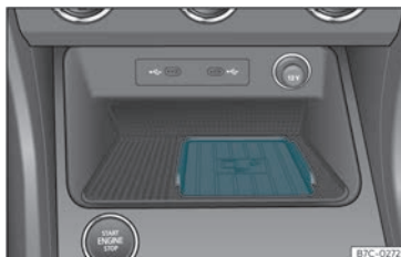
Fig. 136 Na consola central: alojamento para a ligação do telemóvel.
