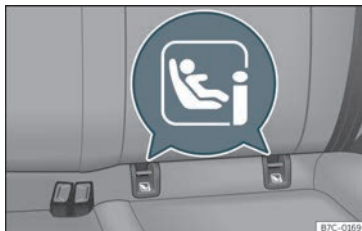
Fig. 25 Banco traseiro: anéis de fixação ISOFIX/i-Size.
