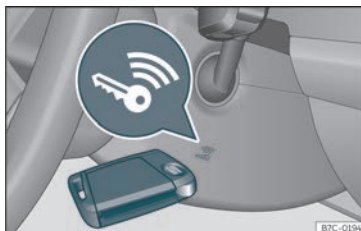
Fig. 140 À direita da coluna de direção: arranque de emergência.
