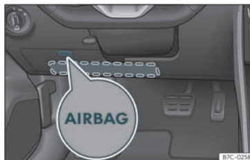
Fig. 17 No lado do condutor: localização do airbag de joelhos.
