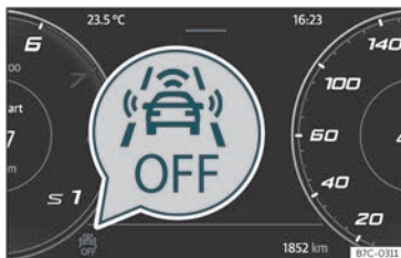
Fig. 159 No ecrã do painel de instrumentos: indicação de Front Assist desativado.
