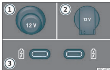
Fig. 127 Tomadas de corrente de 12 Volts do veículo
