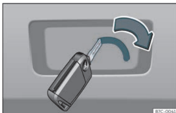
Fig. 87 Pormenor da bagageira: destrancagem de emergência.
