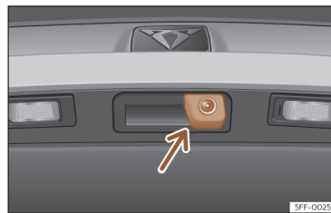
Fig. 132 No manípulo da porta da bagageira: localização da câmara do assistente para marcha-atrás.
