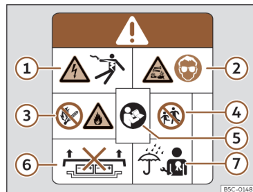
Fig. 56 Rótulo de advertência da bateria de alta tensão.
