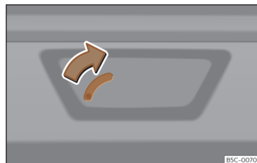
Fig. 84 Pormenor da bagageira: destrancagem de emergência.
