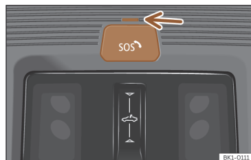
Fig. 37 Na consola do tejadilho: Botão da função de chamada de emergência eCall (atrás da tampa do botão) e luz de controlo (seta).
