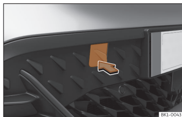
Fig. 45 No para-choques dianteiro direito: Retirar a tampa.
