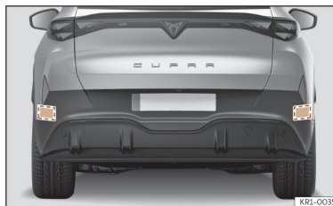
Fig. 112 Vista traseira do veículo: zonas dos sensores de radar.
