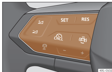
Fig. 119 No volante multifunções: botões para utilizar o ACC.
