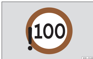
Fig. 9 No ecrã do painel de instrumentos: detetada infração da velocidade máxima permitida (ilustração).
