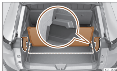
Fig. 169 Na bagageira: fixar o segundo piso da bagageira.
