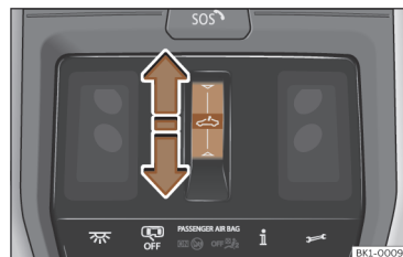
Fig. 100 No revestimento interior do teto: botão de função para utilizar a cortina de proteção contra o sol.
