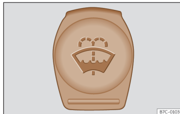
Fig. 199 No compartimento dianteiro: tampa de cor azul do depósito do limpa-vidros.
