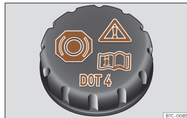
Fig. 198 Compartimento dianteiro: tampa do depósito do líquido dos travões.
