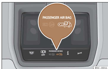
Fig. 28 Na consola do tejadilho: luz de controlo da desativação do airbag do passageiro.
