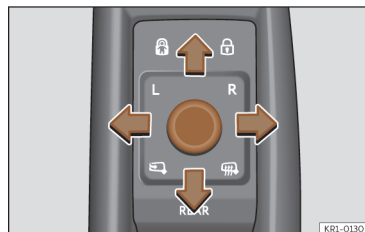
Fig. 98 Pormenor da porta do condutor: comando do espelho retrovisor exterior.
