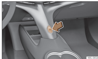
Fig. 45 Consola central: interruptor das luzes de emergência.
