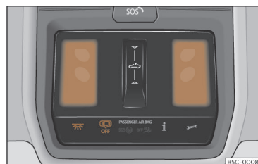
Fig. 94 Pormenor do revestimento do tejadilho: iluminação dianteira do habitáculo.
