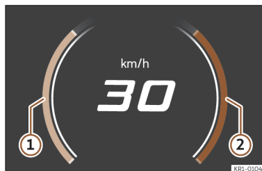
Fig. 4 No painel de instrumentos digital: indicador de potência (representação esquemática).
