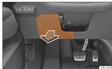
Fig. 190 No painel de instrumentos do lado do condutor: tampa da caixa de fusíveis.
