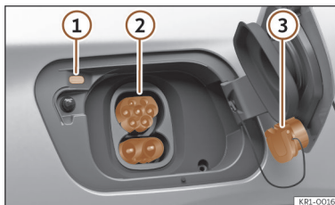
Fig. 58 Por trás da tampa da tomada de carregamento da bateria na parte dianteira esquerda: tomada de carregamento.
