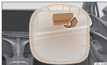
Fig. 26 Airbag do passageiro no painel de instrumentos.
