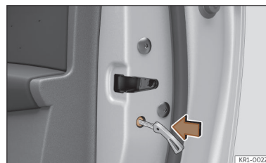
Fig. 75 Trancagem de emergência da porta.
