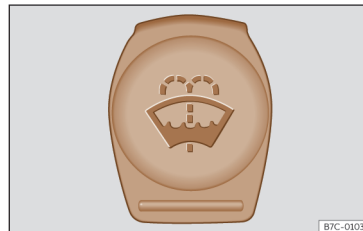
Fig. 202 No compartimento do motor: tampão do reservatório do limpa-vidros.
