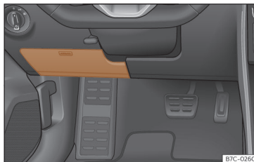
Fig. 45 Veículos com volante à esquerda: tampa da caixa de fusíveis debaixo do painel de instrumentos do lado do condutor
