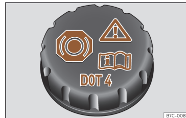
Fig. 201 Compartimento do motor: tampão do depósito do líquido dos travões.
