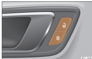
Fig. 70 Porta do condutor: interruptor do fecho centralizado.
