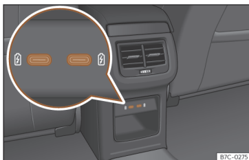
Fig. 133 Parte posterior consola central: conectores USB com função de tomada de corrente.
