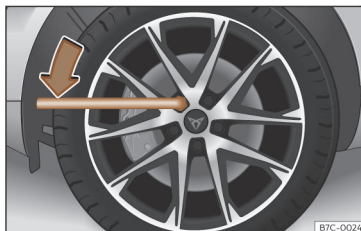
Fig. 34 Substituição da roda: desapertar os parafusos da roda.
