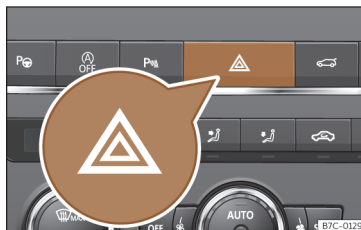
Fig. 90 Painel de instrumentos: interruptor das luzes de emergência
