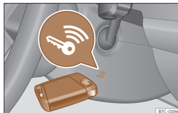
Fig. 135 À direita da coluna de direção: arranque de emergência.
