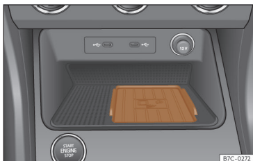
Fig. 131 Na consola central: alojamento para a ligação do telemóvel.
