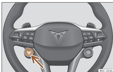
Fig. 142 Volante multifunções: botão para mudar o perfil de condução.
