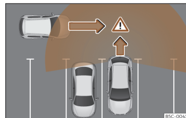
Fig. 167 Representação esquemática do assistente de saída do estacionamento: zona vigiada ao redor do veículo que está a sair do estacionamento.
