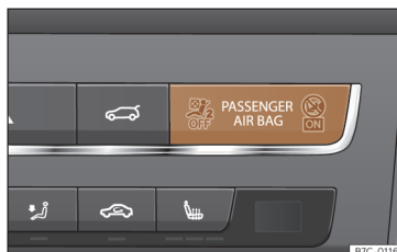
Fig. 16 Painel de instrumentos: luz de controlo da desativação do airbag do passageiro.
