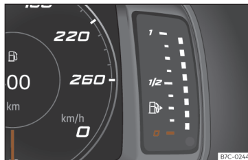
Fig. 54 Indicador do nível de combustível.
