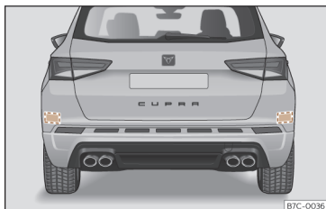
Fig. 146 Vista traseira do veículo: zonas dos sensores de radar.
