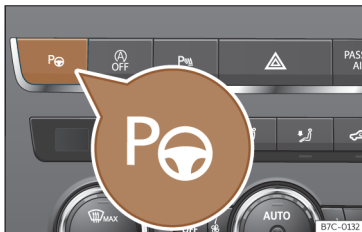
Fig. 170 Na parte superior da consola central: botão para ligar o sistema de estacionamento assistido.
