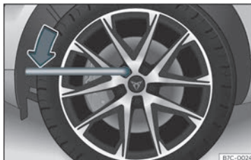
Fig. 34 Substituição da roda: despertar os parafusos da roda.
