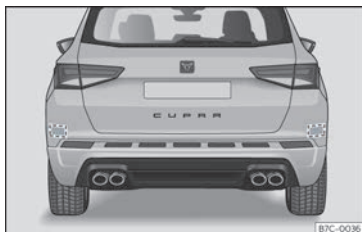
Fig. 151 Vista traseira do veículo: zonas dos sensores de radar.
