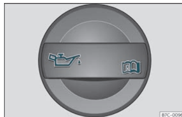
Fig. 203 Tampão do bocal de enchimento do óleo do motor no compartimento do motor.
