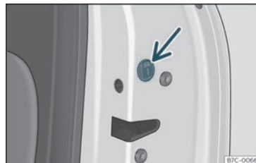
Fig. 80 Trancagem de emergência da porta.
