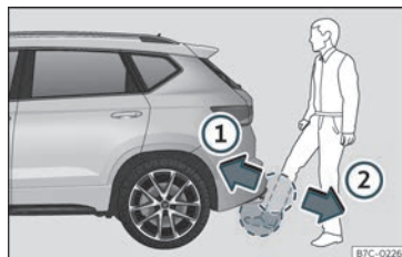
Fig. 85 Porta da bagageira com abertura controlada por sensor (Easy Open)
