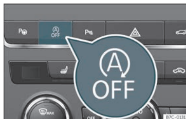
Fig. 141 Consola central: botão do sistema Start/Stop.
