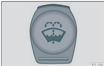
Fig. 207 No compartimento do motor: tampão do reservatório do limpa-vidros.
