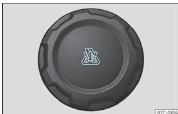
Fig. 205 Compartimento do motor: tampão do depósito de compensação do líquido de refrigeração.
