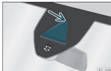
Fig. 222 No para-brisas: área de campo visual do sistema de aviso de saída da faixa de rodagem.
