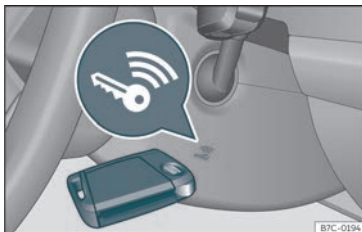
Fig. 198 À direita da coluna de direção: arranque de emergência.
