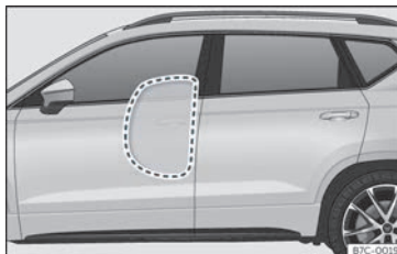
Fig. 19 Airbags laterais ativados totalmente no lado esquerdo do veículo.
