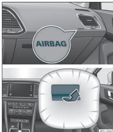
Fig. 13 Airbag do passageiro no painel de instrumentos.
