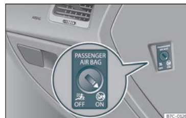
Fig. 14 Comutador com chave para ativar e desativar o airbag do passageiro.
