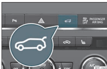
Fig. 79 Consola central: botão para abrir e fechar a porta da bagageira.
