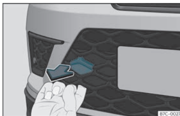
Fig. 39 No lado direito do para-choques dianteiro: retirar a tampa.
