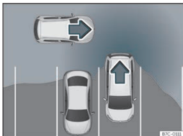
Fig. 229 Representação esquemática do assistente de saída de estacionamento: zona vigiada ao redor do veículo que está a sair do estacionamento.
