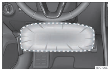
Fig. 17 No lado do condutor: raio de ação do airbag de joelhos.
