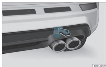
Fig. 41 No lado direito do para-choques traseiro: retirar a tampa.
