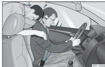
Fig. 7 O passageiro do banco traseiro que não tiver colocado o cinto de segurança é projetado para a frente, para cima do condutor que tem o cinto colocado.
