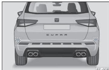
Fig. 226 Vista traseira do veículo: zonas dos sensores de radar.
