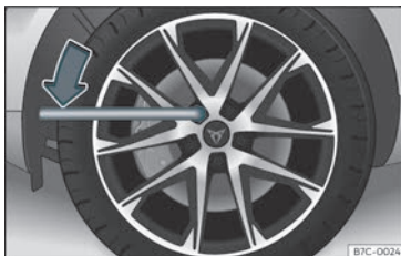
Fig. 32 Substituição da roda: desapertar os parafusos da roda.
