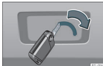
Fig. 82 Pormenor da bagageira: destrancagem de emergência.
