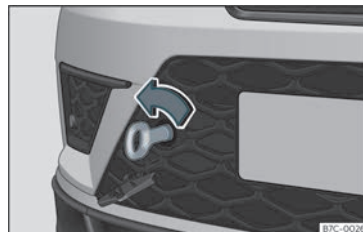
Fig. 40 No lado direito do para-choques dianteiro: argola de reboque enroscada.
