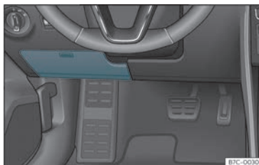
Fig. 43 Veículos com volante à esquerda: tampa da caixa de fusíveis debaixo do painel de instrumentos do lado do condutor
