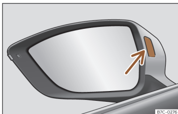
Fig. 120 Luz de controlo do assistente de mudança de faixa.
