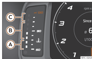
Fig. 4 Indicador de temperatura do líquido de refrigeração do motor.
