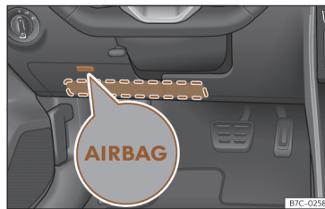
Fig. 30 No lado do condutor: localização do airbag dos joelhos.
