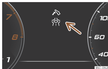
Fig. 7 Indicação da assistência para uma condução ecoeficiente (representação esquemática).
