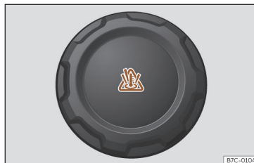
Fig. 195 Compartimento dianteiro: tampão do depósito de expansão do líquido de refrigeração.
