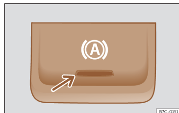
Fig. 125 Na parte inferior da consola central: botão da função Auto Hold.
