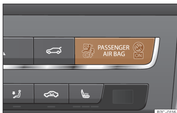
Fig. 26 Painel de instrumentos: luz de controle da desativação do airbag do passageiro.
