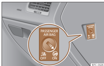
Fig. 25 Comutador com chave para ativar e desativar o airbag do passageiro.
