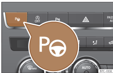
Fig. 131 Na parte superior da consola central: botão para ligar o sistema de estacionamento assistido.
