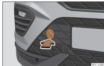
Fig. 184 No lado direito do para-choques dianteiro: retirar a tampa.
