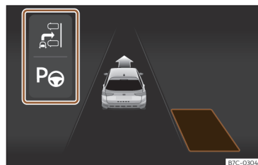
Fig. 132 No ecrã do painel de instrumentos: visualização do sistema de estacionamento assistido com visualização reduzida.
