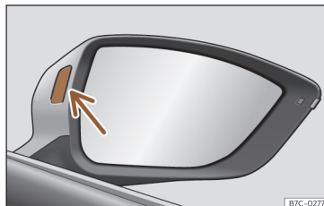
Fig. 121 Luz de controlo do assistente de mudança de faixa.
