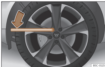
Fig. 210 Troca de roda: desapertar os parafusos de roda.
