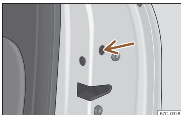
Fig. 52 Trancagem de emergência da porta.
