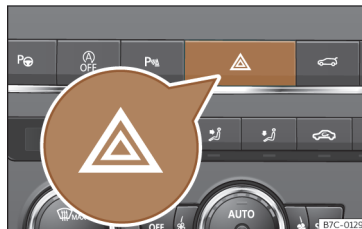
Fig. 40 Pannel de instrumentos: interruptor das luzes de emergência.
