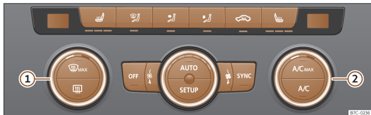
Fig. 86 Na consola central: comandos do Climatronic.
