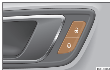
Fig. 49 Na porta do condutor: interruptor do fecho centralizado.
