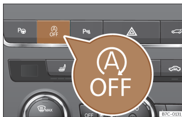
Fig. 91 Consola central: botão do sistema Start-Stop.
