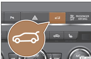
Fig. 56 Consola central: botão para abrir e fechar a porta da bagageira.
