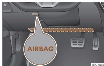
Fig. 35 No lado do condutor: localização do airbag dos joelhos.
