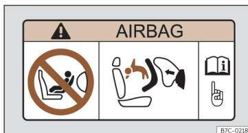
Fig. 38 Autocolante do airbag: na pala do sol do lado do passageiro.
