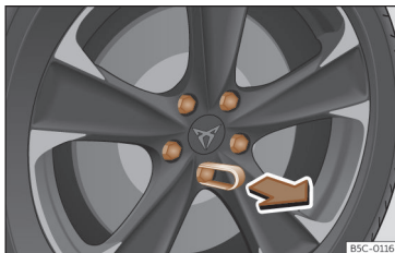
Fig. 240 Roda: parafusos de roda com protetores.
