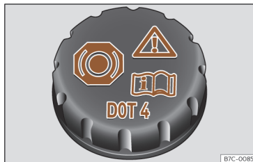
Fig. 225 Compartimento dianteiro: tampa do depósito do líquido dos travões.
