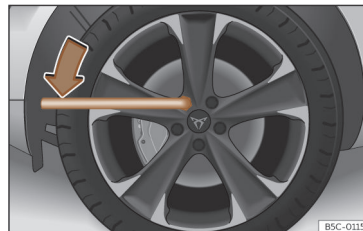
Fig. 242 Troca de roda: desapertar os parafusos de roda.
