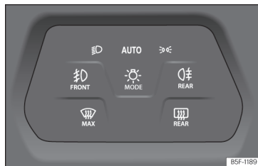
Fig. 107 Painel de instrumentos: comando das luzes.
