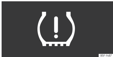
Fig. 245 Painel de instrumentos: aviso de perda de pressão dos pneus.
