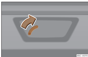
Fig. 88 Pormenor da bagageira: destrancagem de emergência.
