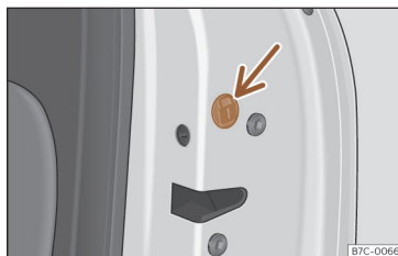
Fig. 81 Trancagem de emergência da porta.
