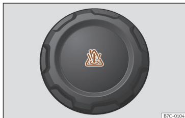
Fig. 224 Compartimento dianteiro: tampão do depósito de expansão do líquido de refrigeração.
