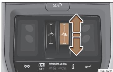
Fig. 92 No revestimento interior do teto: manusear a cortina de proteção contra o sol.
