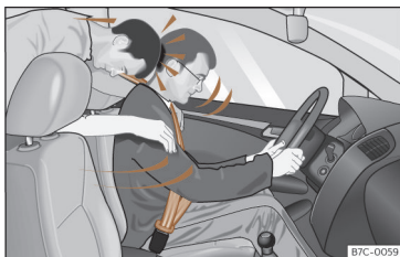
Fig. 21 O passageiro do banco traseiro que não tiver colocado o cinto de segurança é projetado para a frente, para cima do condutor que tem o cinto colocado.
