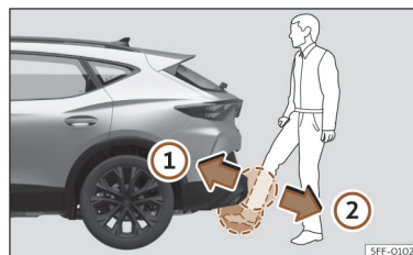
Fig. 86 Porta da bagageira com abertura controlada por sensor (Easy Open)
