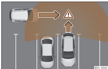
Fig. 169 Representação esquemática do assistente de saída do estacionamento: zona vigiada ao redor do veículo que está a sair do estacionamento.
