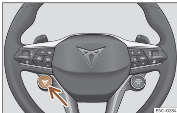
Fig. 128 Volante multifunções: botão para mudar o perfil de condução.
