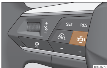
Fig. 130 Lado esquerdo do volante multifunções: botão para os sistemas de assistência à condução (conforme versões).
