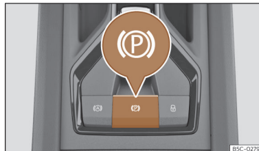
Fig. 155 Na parte inferior da consola central: botão do travão de estacionamento eletrónico.
