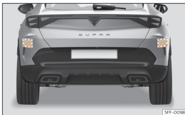
Fig. 134 Vista traseira do veículo: zonas dos sensores de radar.
