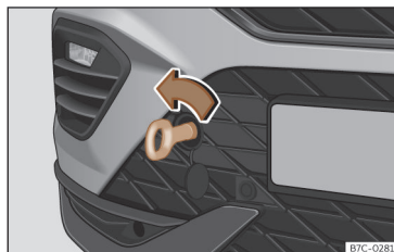
Fig. 184 Parte direita do para-choques dianteiro: argola de reboque enroscada.
