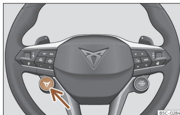
Fig. 120 Volante multifunções: botão para mudar o perfil de condução.
