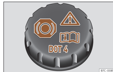
Fig. 224 Compartimento dianteiro: tampa do depósito do líquido dos travões.
