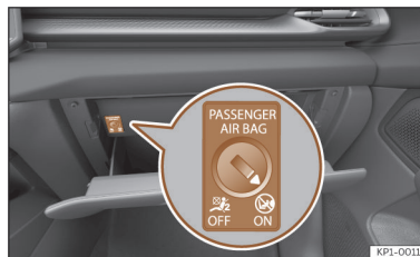
Fig. 30 Comutador com chave para ativar e desativar o airbag do passageiro.
