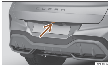
Fig. 128 No manípulo da porta da bagageira: localização da câmara do assistente para marcha-atrás.
