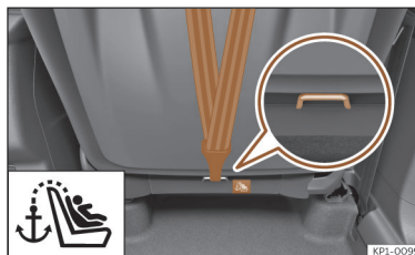
Fig. 44 Parte posterior do encosto do banco do passageiro: fixação para o cinto Top Tether (não está disponível em todos os mercados).
