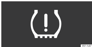
Fig. 244 Painel de instrumentos: aviso de perda de pressão dos pneus.
