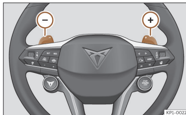
Fig. 119 Volante: alavancas para mudança automática de velocidades.
