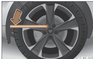
Fig. 241 Troca de roda: desapertar os parafusos de roda.
