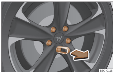
Fig. 239 Roda: parafusos de roda com protetores.
