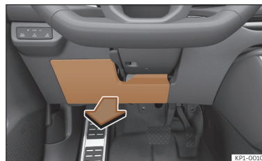
Fig. 215 No painel de instrumentos do lado do condutor: tampa da caixa de fusíveis.
