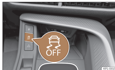
Fig. 121 Na parte inferior da consola central: botão para ligar/desligar o ESC.
