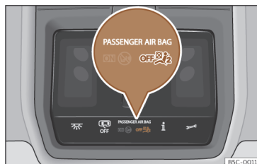
Fig. 31 Na consola do tejadilho: luz de controlo da desativação do airbag do passageiro.
