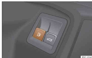
Fig. 202 Porta do condutor: desbloqueio da tampa do depósito.
