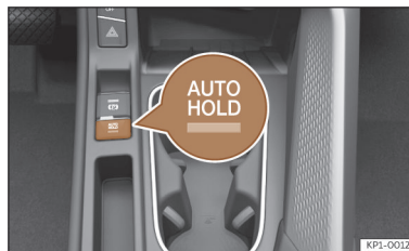
Fig. 148 Na parte inferior da consola central: botão da função Auto Hold.
