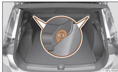
Fig. 182 Na bagageira: desmontar e montar a chapeleira.
