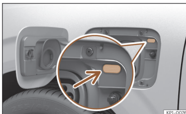
Fig. 61 Por trás da tampa da tomada de carregamento da bateria: indicador do processo de carregamento.
