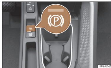
Fig. 147 Na parte inferior da consola central: botão do travão de estacionamento eletrónico.
