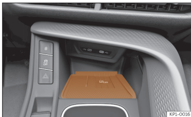
Fig. 180 Na consola central: alojamento para a ligação do telemóvel.
