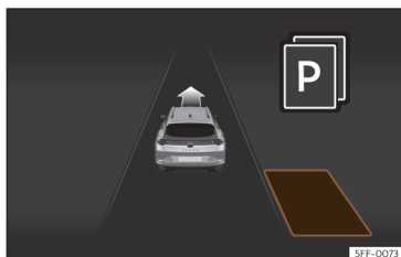
Fig. 149 No ecrã do painel de instrumentos: visualização do sistema de estacionamento assistido com visualização reduzida.
