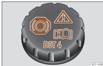
Fig. 218 Compartimento do motor: tampa do depósito do líquido dos travões.
