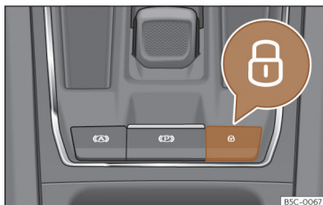
Fig. 71 Consola central: interruptor do fecho centralizado.
