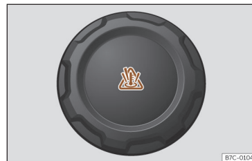
Fig. 217 Compartimento dianteiro: tampão do depósito de expansão do líquido de refrigeração.
