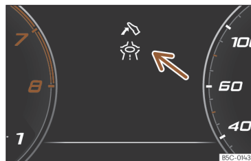
Fig. 10 Indicação da assistência para uma condução ecoeficiente (representação esquemática).
