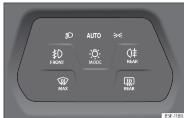
Fig. 99 Painel de instrumentos: comando das luzes.
