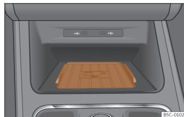
Fig. 170 Na consola central: alojamento para a ligação do telemóvel.
