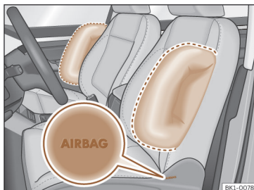
Fig. 33 Airbag lateral no banco do condutor e do passageiro.
