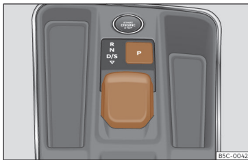
Fig. 115 Na consola central: comando seletor.
