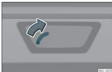
Fig. 81 Pormenor da bagageira: destrancagem de emergência.
