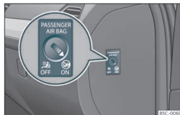
Fig. 15 Comutador com chave para ativar e desativar o airbag do passageiro.
