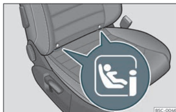
Fig. 28 Banco passageiro dianteiro: anéis de fixação ISOFIX/i-Size.
