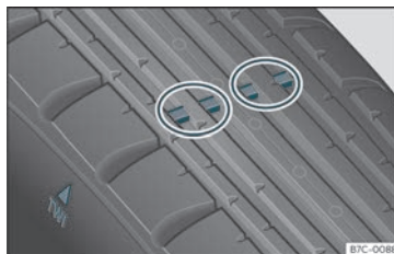
Fig. 194 Perfil do pneu: indicadores de desgaste.
