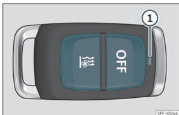
Fig. 125 Aquecimento estacionário: comando à distância por radiofrequência.
