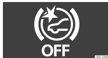
Fig. 150 No ecrã do painel de instrumentos: indicação de Front Assist desativado.
