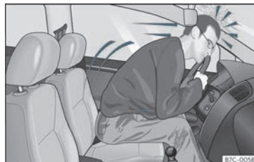
Fig. 7 O condutor que não tiver colocado o cinto de segurança será projetado para a frente.
