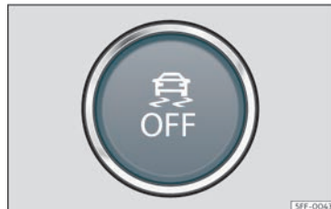
Fig. 169 Na parte inferior da consola central: botão para ligar/desligar o ESC
