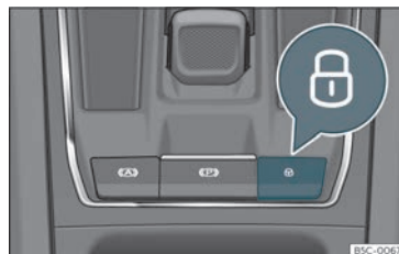
Fig. 71 Na consola central: interruptor do fecho centralizado
