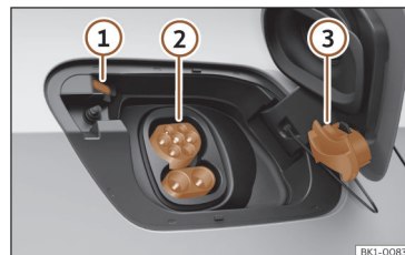
Fig. 69 Por trás da tampa da tomada de carregamento da bateria na parte dianteira esquerda: tomada de carregamento.
