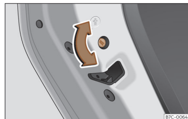
Fig. 88 Sistema de segurança para crianças da porta esquerda.
