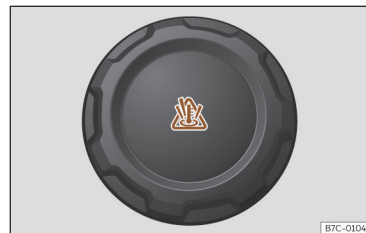
Fig. 210 Compartimento dianteiro: tampa do depósito de expansão do líquido de refrigeração.
