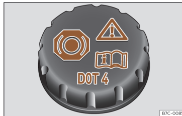
Fig. 211 Compartimento do motor: tampa do depósito do líquido dos travões.
