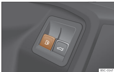
Fig. 192 Porta do condutor: desbloqueio da tampa do depósito.
