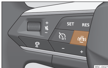
Fig. 121 Lado esquerdo do volante multifunções: botão para os sistemas de assistência à condução (conforme versões).
