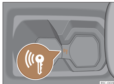
Fig. 113 Na consola central: arranque de emergência.
