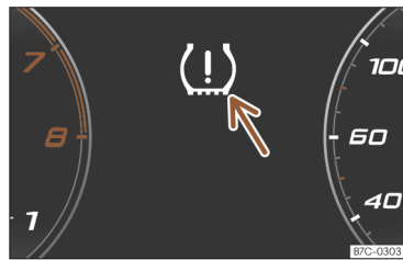
Fig. 229 Painel de instrumentos: aviso de perda de pressão dos pneus.
