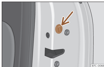
Fig. 73 Trancagem de emergência da porta.
