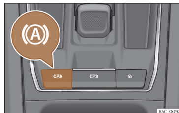
Fig. 147 Na parte inferior da consola central: botão da função Auto Hold.
