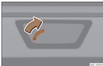
Fig. 80 Pormenor da bagageira: destrancagem de emergência.
