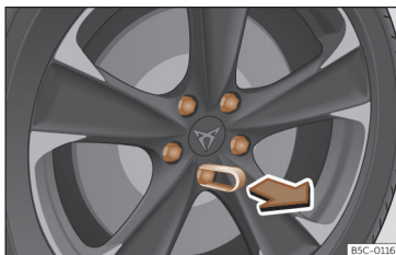
Fig. 224 Roda: parafusos de roda com protetores.
