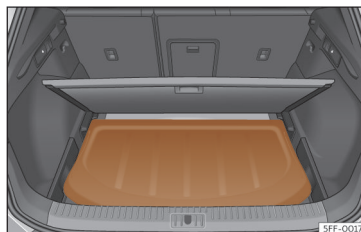
Fig. 176 Na bagageira: colocação da chapeleira.
