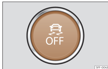
Fig. 119 Na parte inferior da consola central: botão para ligar/desligar o ESC
