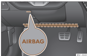
Fig. 36 No lado do condutor: localização do airbag dos joelhos.
