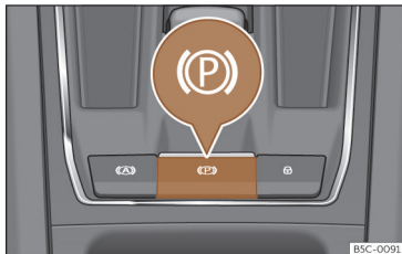
Fig. 146 Na parte inferior da consola central: botão do travão de estacionamento eletrônico.
