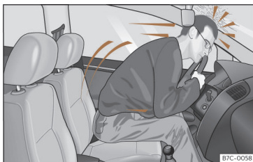
Fig. 21 O condutor que não tiver colocado o cinto de segurança será projetado para a frente.
