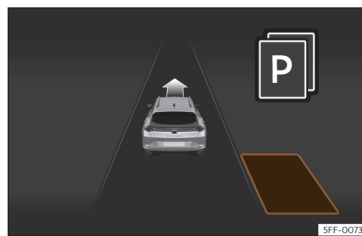
Fig. 150 No ecrã do painel de instrumentos: visualização do sistema de estacionamento assistido com visualização reduzida.
