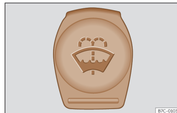
Fig. 212 No compartimento dianteiro: tampa de cor azul do depósito do limpa-vidros.
