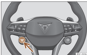
Fig. 118 Volante multifunções: botão para mudar o perfil de condução.
