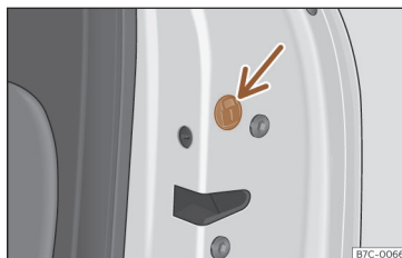
Fig. 73 Trancagem de emergência da porta.
