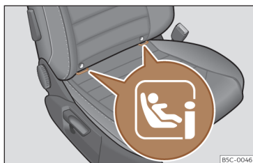
Fig. 42 Banco passageiro dianteiro: localização dos anéis de fixação i-Size.
