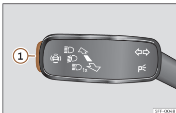
Fig. 120 Na alavanca das luzes indicadoras de mudança de direção e dos máximos: botão dos sistemas de assistência ao condutor (conforme versões).
