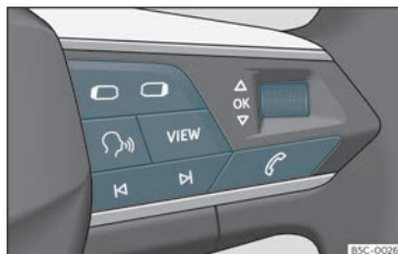
Fig. 56 Lado direito do volante multifunções: botões para utilizar os menus e as indicações informativas do painel de instrumentos (conforme versões).
