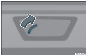
Fig. 81 Pormenor da bagageira: destrancagem de emergência.
