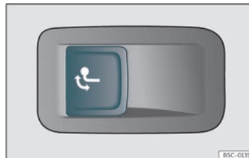
Fig. 179 No lado esquerdo da bagageira: botão para desbloquear o gancho de reboque.
