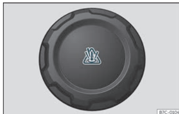
Fig. 189 Compartimento do motor: tampão do depósito de compensação do líquido de refrigeração.
