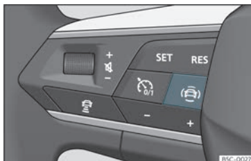
Fig. 58 Lado esquerdo do volante multifunções: botão para os sistemas de assistência à condução (conforme versão).
