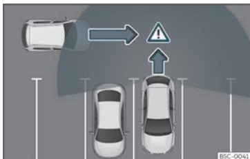
Fig. 164 Representação esquemática do assistente de saída do estacionamento: zona vigiada ao redor do veículo que está a sair do estacionamento.
