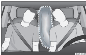
Fig. 20 Airbag central ativado totalmente (raio de alcance).
