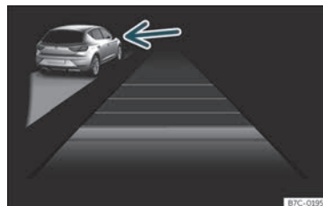
Fig. 153 No ecrã do painel de instrumentos: ACC ativo, veículo detetado pela esquerda
