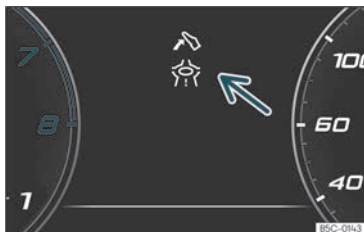
Fig. 54 Indicação da assistência para uma condução ecoeficiente (representação esquemática).
