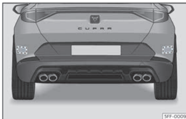
Fig. 143 Vista traseira do veículo: zonas dos sensores de radar.
