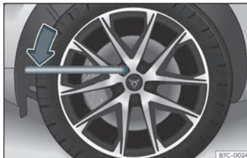
Fig. 37 Substituição da roda: desapertar os parafusos da roda.
