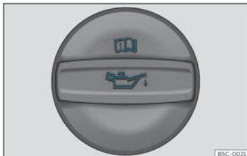
Fig. 187 Tampão do bocal de enchimento do óleo do motor no compartimento do motor.
