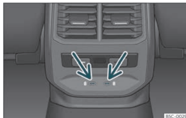
Fig. 133 Parte posterior consola central: conetores USB com função de tomada de corrente.
